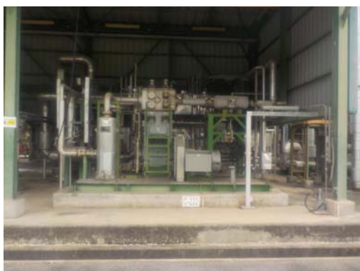
รูปที่ 3.4 Flash Gas Compressor (C-222)
