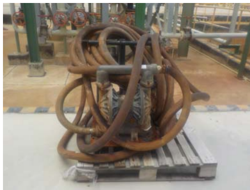
รูปที่ 3.17 Diaphragm Pump
